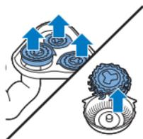
Remarque : Ne nettoyez qu'une lame et une grille à la fois, car elles sont assemblées par paires. Si vous intervertissez accidentellement des lames et des grilles, plusieurs semaines peuvent être nécessaires avant de retrouver un rasage optimal.
