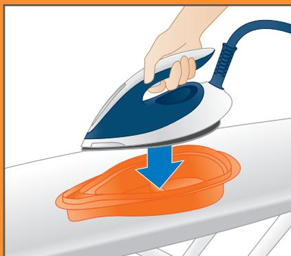
Placez le fer sur le réservoir anticalcaire, sur une surface plane et stable.
