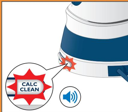
Détartrez votre appareil lorsque le voyant de détartrage clignote et que l'appareil émet des signaux sonores.
