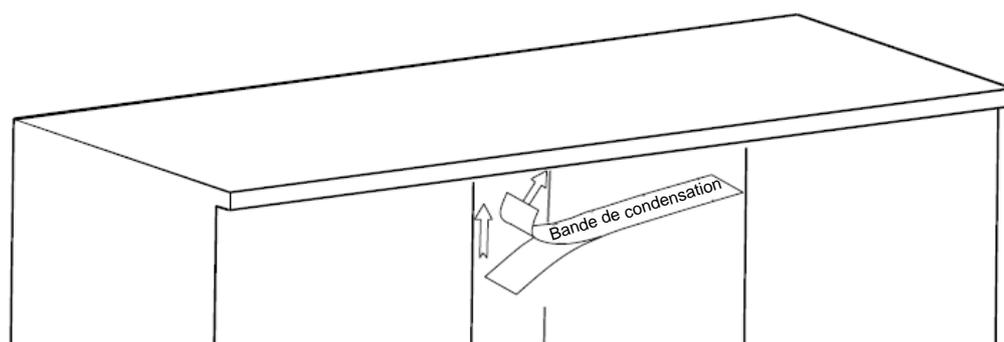
La bande de condensation doit être montée sur la face inférieure du plan de travail pour le protéger contre la pénétration de l'humidité.
