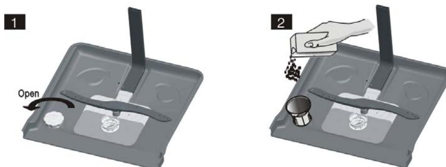
Remettez le bouchon en place en le vissant dans le sens des aiguilles d'une montre.
