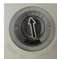
**REMARQUE :** Si la vaisselle est terne ou présente des taches circulaires, la quantité de liquide de rinçage doit être augmentée. Si la vaisselle est collante ou présente des rayures blanchâtres, la quantité de liquide doit être diminuée.
