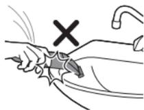
**Attention : Ne tapotez pas l'appareil contre une surface pour en retirer l'eau, car il risque d'être endommagé. Remplacez la lame si elle est endommagée.**
