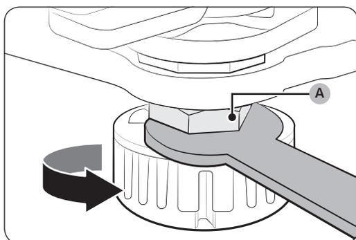
1. Ouvrez la porte pour la régler et repérez les deux écrous (A) et (B) en bas de la façade de la porte.
