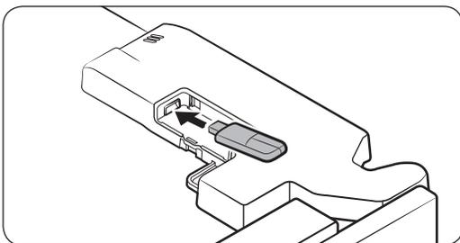
3. Insérez le Smart Home Adapter dans le port d'adaptateur dans le bon sens.
