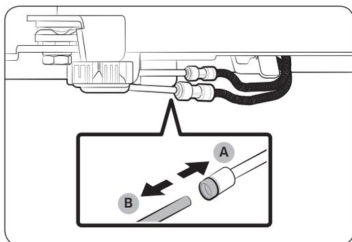
1. En partant de la partie basse à l'arrière du réfrigérateur, faites sortir le tuyau d'eau à l'avant.
