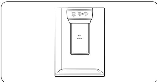
1. Avec la fonction Ice Maker (Machine à glaçons) activée, appuyez sur le bouton **Cubed Ice (Glaçons)** ou **Crushed Ice (Glace pilée)** pour sélectionner le type de glace.
