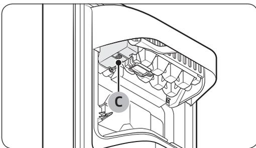
Si vous n'arrivez pas à verser de la glace, vérifiez d'abord la machine à glaçons. Vérifiez qu'elle fabrique correctement des glaçons.
