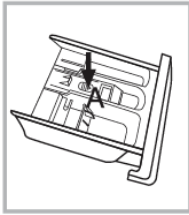
1. Ouvrez le tiroir à détergent en appuyant sur A
