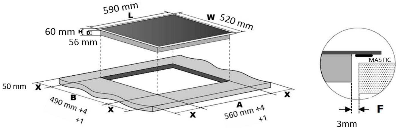
Il est essentiel que la plaque de cuisson soit bien ventilée et que les entrées et sorties d'air ne soient pas bouchées. Vérifiez que la plaque de cuisson est correctement installée comme illustré.
