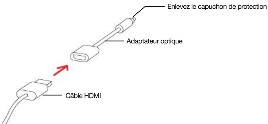
3. Branchez l'adaptateur optique au port **de sortie (OUT) numérique optique** de la TV.
