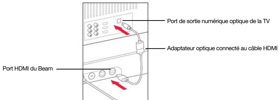
**Remarque:**Le port de l'adaptateur optique est en forme de D. Assurez-vous par conséquent d'aligner correctement le connecteur dans le port. Une insertion incorrecte de l'adaptateur risque d'endommager le câble.
