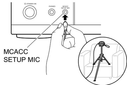
Pour mettre un microphone de configuration d'enceinte sur un trépied, consultez l'illustration en le mettant en place.
