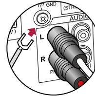
Si la platine disque a un fil de mise à la terre, branchez-le à la borne GND de cet appareil.
