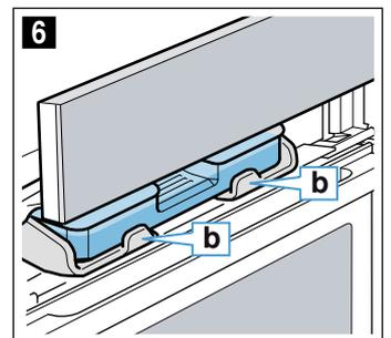
9. Pousser lentement le bandeau vers le bas, puis l'enfoncer vers l'arrière jusqu'à ce qu'il soit entièrement fermé. Le réservoir d'eau est rempli. Vous pouvez démarrer des modes avec de la vapeur.
