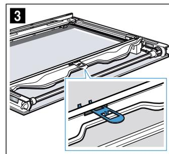
3. Placez la vitre intérieure à gauche et à droite dans la fixation **c** (figure 4).
