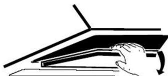
Positionnez le filtre à charbon actif dans le bloc et tournez-le dans le sens des aiguilles d'une montre. Faites pareil de l'autre côté.
