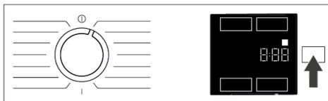
Si le niveau d'eau dans la machine est inapproprié lorsque vous appuyez sur le bouton Marche/Pause, le verrouillage de porte ne peut pas être désactivé et son icône reste active à l'écran.
