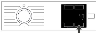
Chaque fois qu'un nouveau programme est sélectionné, après un certain temps, l'info température recommandée pour le programme apparaît sur l'indicateur de durée.. Il est possible que la température recommandée ne soit pas la température maximale pouvant être sélectionnée pour le programme en cours.
