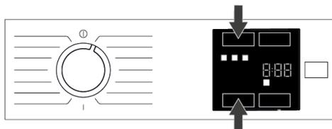
Sélectionnez les fonctions auxiliaires souhaitées avant de lancer le programme. Lorsqu'un programme est sélectionné, les icônes des symboles des fonctions auxiliaires compatibles avec le programme s'affichent.
