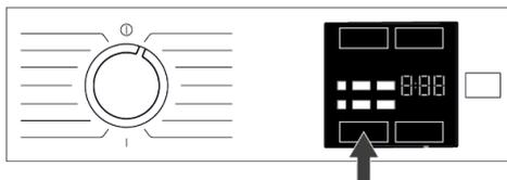
Chaque fois qu'un nouveau programme est sélectionné, la vitesse d'essorage recommandée du programme sélectionné s'affiche sur le voyant de vitesse d'essorage. Il est possible que la vitesse d'essorage recommandée ne soit pas la valeur maximale pouvant être sélectionnée pour le programme en cours.
