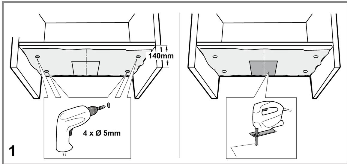
2. Si vous souhaitez utiliser la hotte en mode d'évacuation extérieure, créez une découpe pour le tuyau d'évacuation de l'air vicié : Notez que le diamètre de la gaine de sortie d'air doit être de 120mm.
