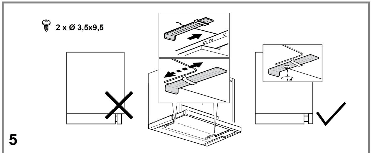
3. Retirez le filtre à graisse métallique. Faites glisser la butée vers l'avant jusqu'à ce qu'elle soit appuyée contre le tiroir du filtre. Dans cette position, vissez la butée pour la maintenir en place avec les 2 vis fournies (diamètre 3,5mm ; profondeur 9,5mm).
