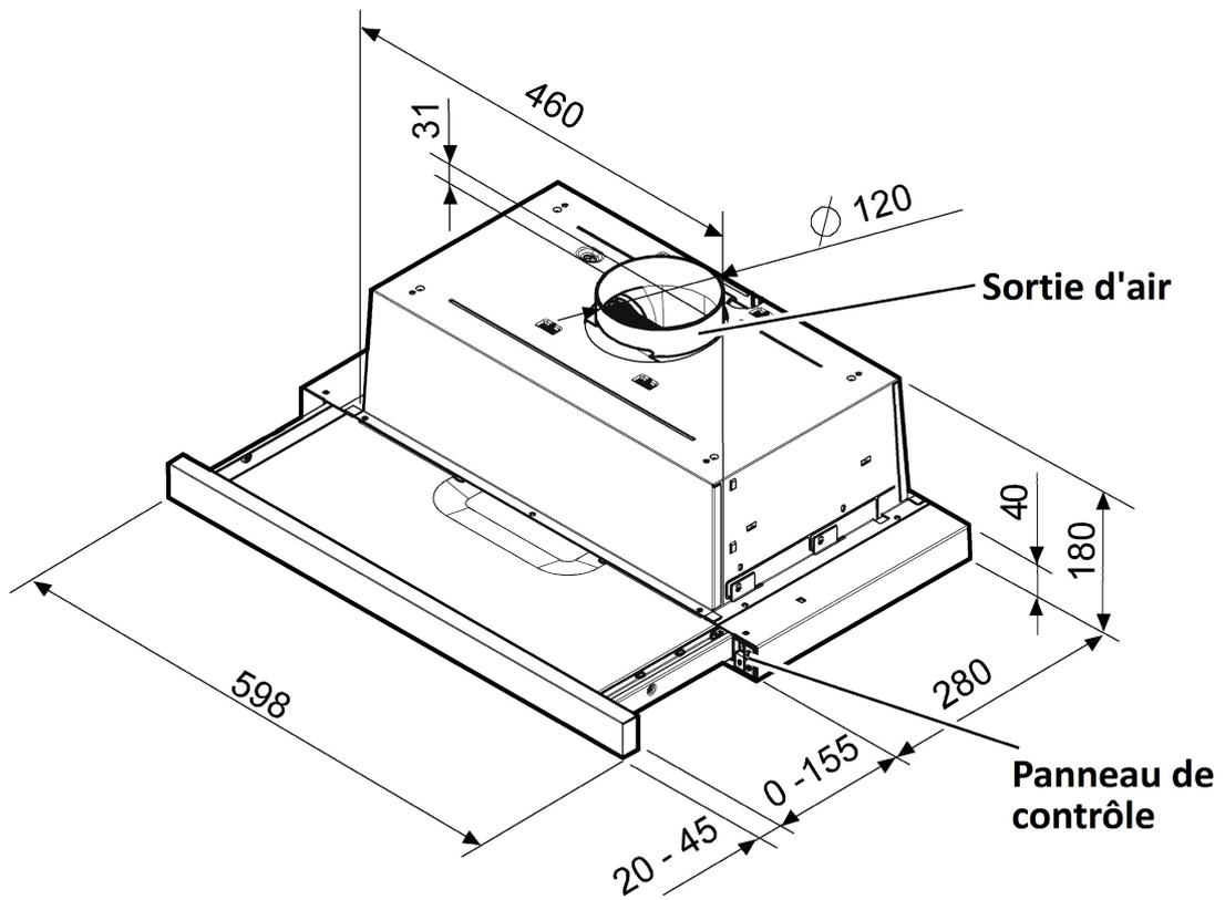
La hotte peut être utilisée en version aspirante à évacuation extérieure, ou filtrante à recyclage intérieur.
