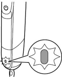
Lorsque l'appareil est en charge, le témoin d'état de la batterie clignote en vert.
