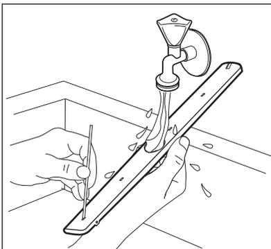
5. Pour réinstaller le bras d'aspersion, insérez la fixation dans le bras d'aspersion et insérez-le dans le tuyau d'alimentation en le tournant vers la droite. Assurez-vous que la fixation se verrouille correctement dans la bonne position.
