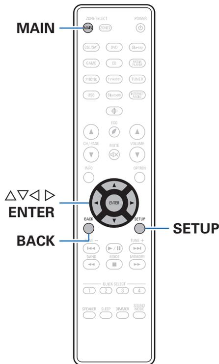
**1** Appuyez sur **MAIN** sur la télécommande pour régler la zone de fonctionnement sur **MAIN ZONE**.
