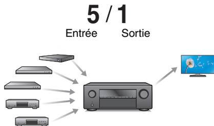
Cet appareil est équipé de 5 entrées HDMI et de 1 sortie HDMI permettant la connexion à divers appareils compatibles HDMI tels que des lecteurs Blu-ray Disc, des consoles de jeux et des caméscopes HD.
