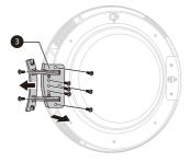
3 Retirer les 3 vis de la serrure de porte (4) qui est fixée entre la porte et l'assemblage de charnière, puis retirer la vis qui est fixée sur le crochet de la porte.
