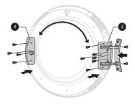
Retirer le loquet de la porte (5) du cadre de l'appareil en retirant les 2 vis, puis les assembler du côté opposé.
