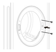
7 Installer la porte avec les vis retirées à l'étape 1, puis vérifier que la porte se ferme correctement.
