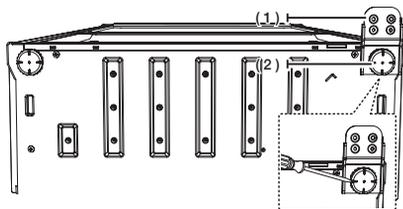
8. Retirez la vis (1) placée sous la porte du réfrigérateur et du congélateur, à droite.
