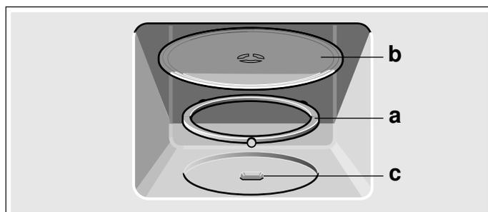
**Remarque :** Utilisez l'appareil uniquement avec le plateau tournant en place. Veillez à ce qu'il soit correctement enclipsé. Le plateau tournant peut tourner à gauche ou à droite.
