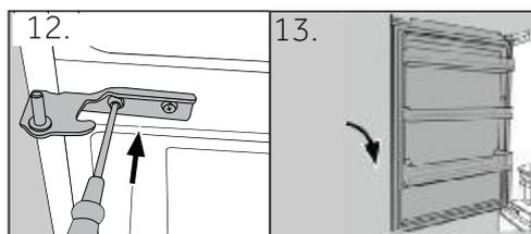
12. Sortez la nouvelle charnière inférieure de la porte supérieure du sac contenant les accessoires et vissez-la sur le côté gauche de l'appareil.
