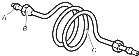
A. Bague de compression C. Canalisation en cuivre
