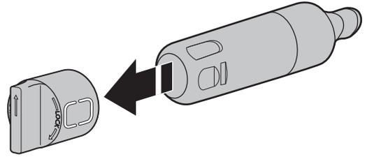
5. Installer le capuchon de filtre à eau sur le nouveau filtre. Aligner correctement les flèches pour que les rainures du filtre soient alignées avec les nervures du capuchon.
