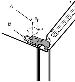
A. Vis à tête creuse de 5 mm
