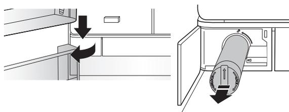
**REMARQUE :** Si le filtre n'est pas installé correctement, le débit d'eau sera plus faible et la production de glaçons plus lente. La mauvaise installation d'un filtre peut aussi laisser fuir le compartiment du filtre.
