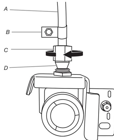
A. Canalisation en cuivre C. Écrou à compression
