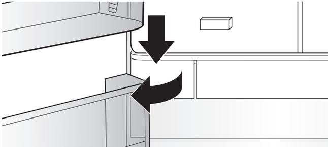
2. Pivoter le filtre à eau et tourner de 90° dans le sens antihoraire pour le déverrouiller.
