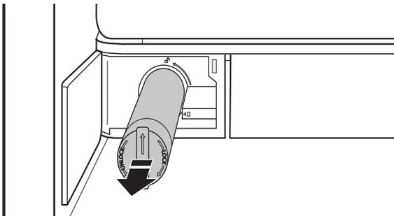
4. Retirer le capuchon du filtre à eau qui doit être remplacé.
