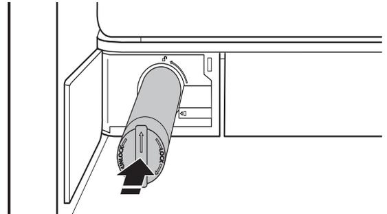
7. Pivoter le filtre à eau et tourner de 90° dans le sens horaire pour le verrouiller en place et aligner les flèches.
