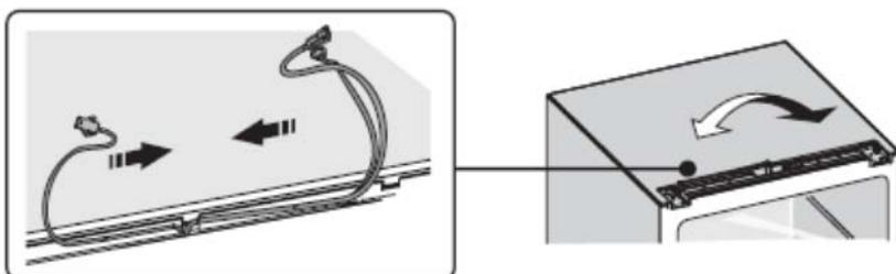
8. Installez la charnière supérieure sur le côté opposé avec les vis. Déplacez le fil de connexion dans la rainure opposée.
