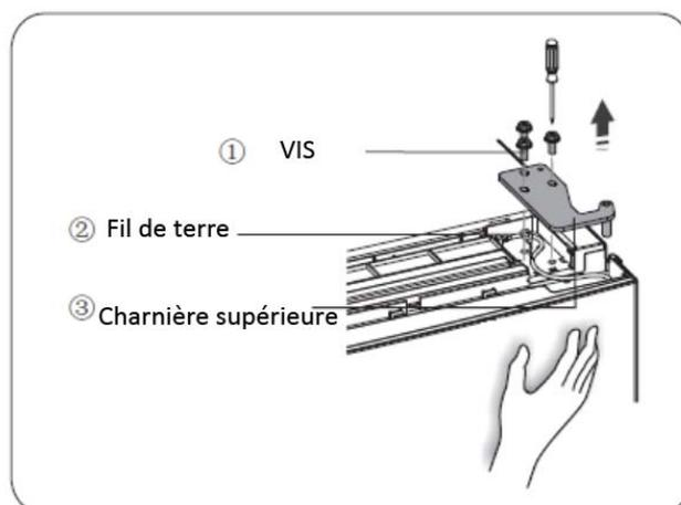
3. Soulevez la porte du congélateur pour l'enlever de l'appareil et mettez-la de côté sur une surface souple.
