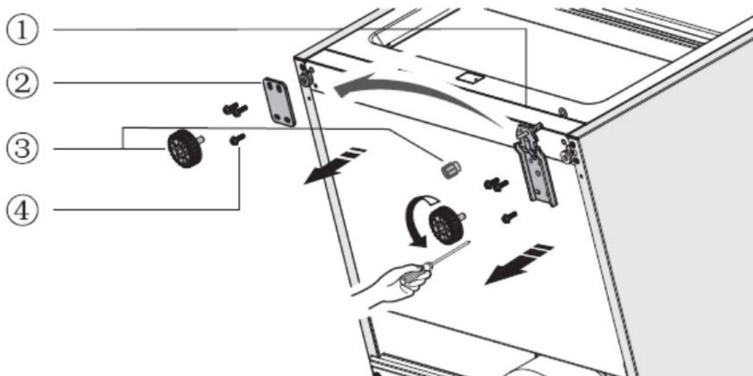
5. Transférez la charnière inférieure sur le côté opposé. Placez la porte sur la goupille de la charnière inférieure, fixez la charnière inférieure avec les vis puis installez le pied de réglage.
