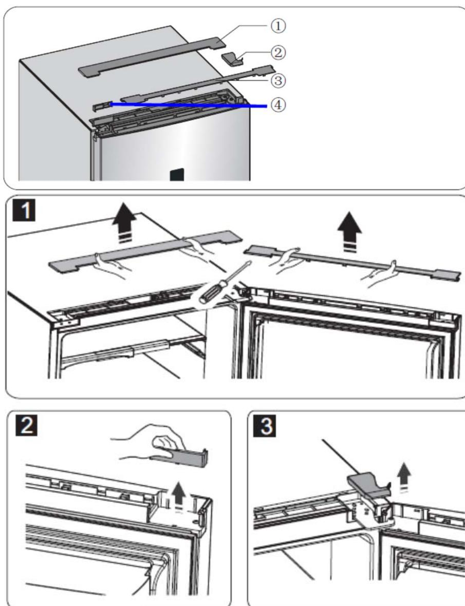
Débranchez les connecteurs électriques, puis retirez le couvercle de coin ④.
