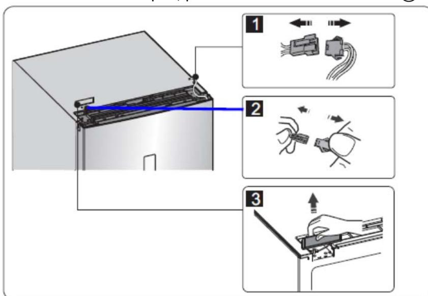
2. Enlevez les vis qui maintiennent la charnière supérieure du châssis. Desserrez le fil de terre et retirez la charnière supérieure.
