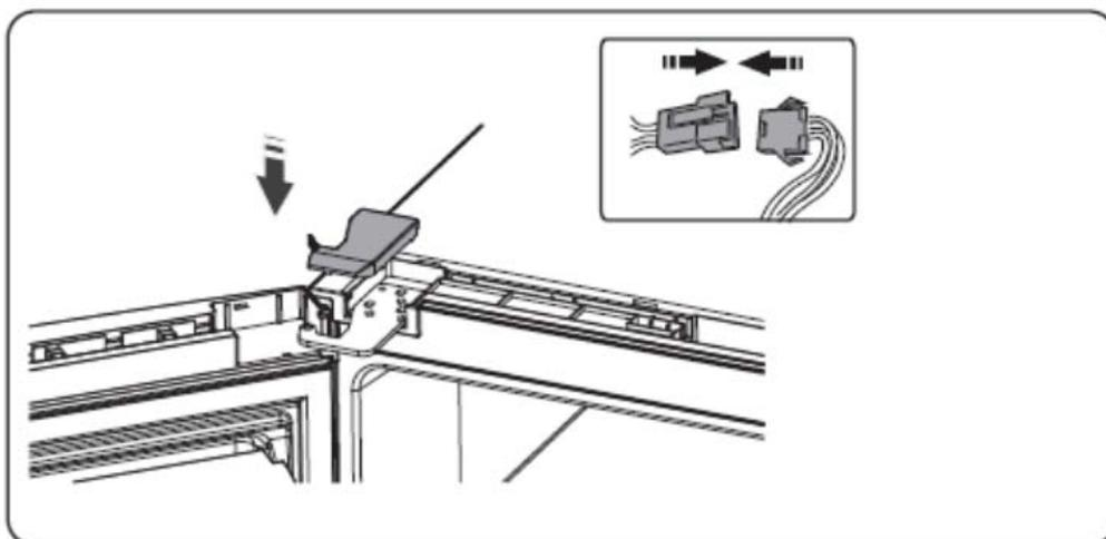
10. Inversez le couvercle de coin en le plaçant sur le coin opposé de la porte. Replacez le couvercle sur la rainure où passent les fils.
