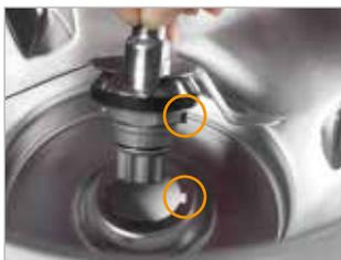
Insérez la lame dans le trou en fond de cuve. Retournez la cuve en maintenant le couteau dans le fond de la cuve.
