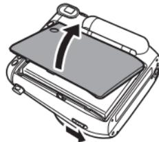
Faites pression sur le verrou du couvercle arrière pour l'ouvrir.
